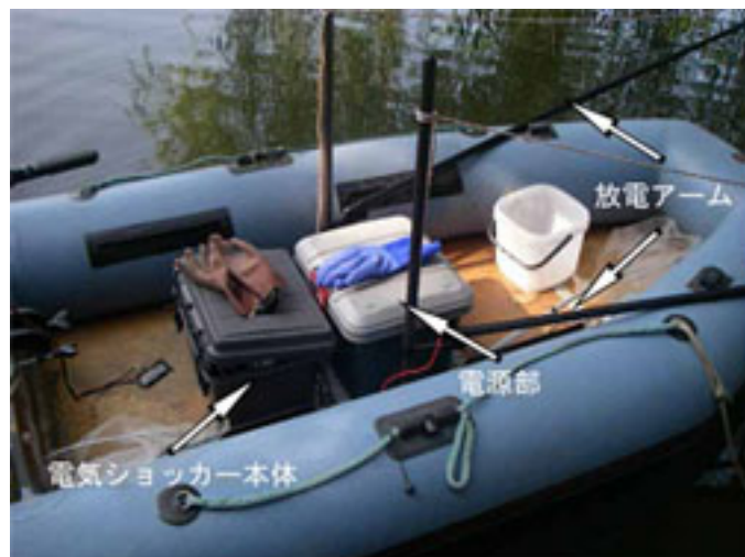
図-1 電気ショッカーボート概要
